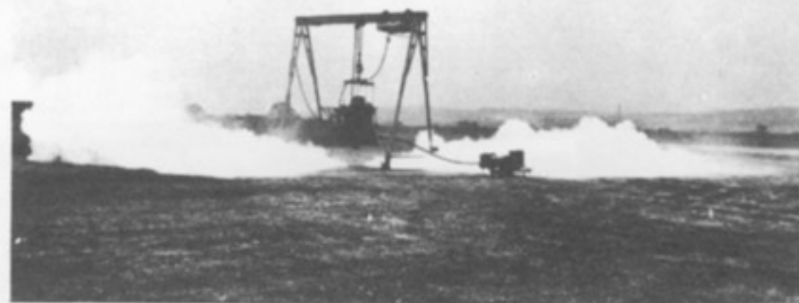
RB108 exhaust visualisation testing
